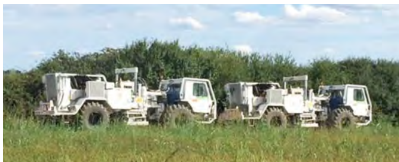
6. ábra | 25 tonnás HEMI 50 típusú vibrátorok működés közben Figure 6 | HEMI 50 type vibrators on the site – with weight of 25 tons
