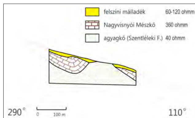
17. ábra A 7-8-as szelvény alatti földtani metszet a Köpös-forrás környékén, GBR-adó
