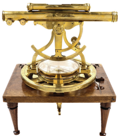
56. ábra. A Benjamin Cole-féle teodolit az 1760-as évekből, forrás: Russ Uzes, 2020
