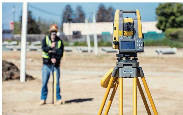
40. ábra. Mérőállomás felmérés közben, forrás: Arka Roy, 2023
