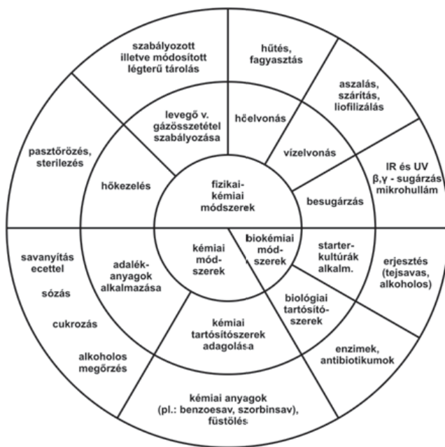
58. ábra. Élelmiszeripari alapanyagok tartósítási eljárásai
