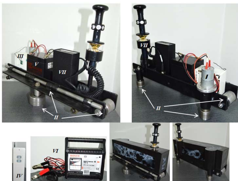
13. ábra. A prizmahordozó robot fizikai összetevői
