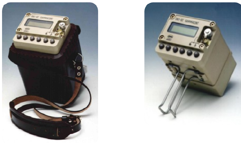
1. ábra. Hordtáskában dozimetriai műszer, szabadon szennyezettség-mérő
