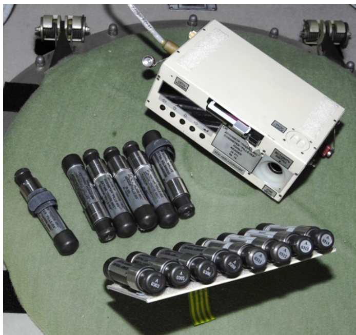
4. ábra. Pille készülék és dózismérői. A kiolvasásra váró dózismérők átmeneti rögzítéséhez rendelkezésre áll egy bogáncszárral borított lap.
