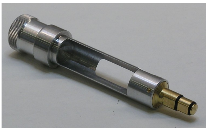
15. ábra. Az űrséta dózismérők kiolvasására szolgáló dózismérő tartó és az abba helyezhető dózismérő patron
