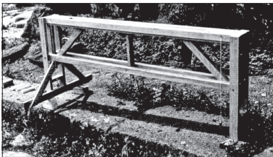
Abb. 22: Chorobates . Rekonstruktion von J.-P. Adam (ADAM 1989, 18)
