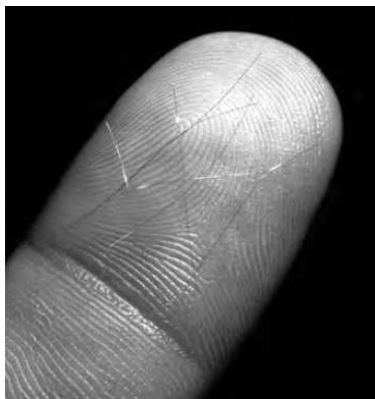
6. ábra: Az 1960-as években a West Ford projekt keretében 350 millió ilyen apró rézdrótot szórtak szét az Egyenlítő vonalára merőlegesen, amiket egy biztonságos kommunikációs rendszer részeként képzeltek el [14]
