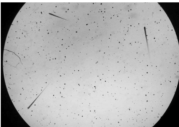
1. ábra: A nyomdetektor felszíne 15 óra maratást követően, négyszeres nagyításban.
