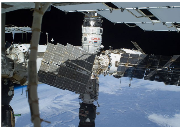
2. ábra: A Nemzetközi Űrállomás orosz szegmensei: zenit irányban az MRM-2 (Poiszk), a Föld felé, azaz nadir irányban a Pirsz, az űrállomás végében (jobbra) pedig a szerviz modul látható. (Fotó: Roszkoszmosz)
