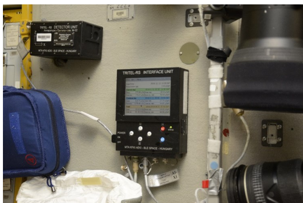
2. ábra: A TRITEL-RS rendszer az ISS Zvezda moduljában 2019-ben. (Fotó: Roszkosmosz / RSC Enyergija)
