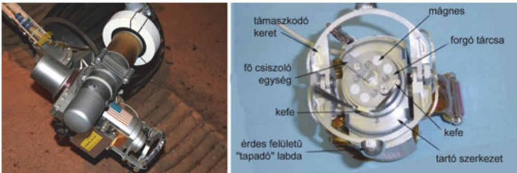
6. ábra: A RAT képe egy földi tesztrover robotkarjának végén (balra) és szerkezeti egységei szemből nézve (jobbra) [6]
