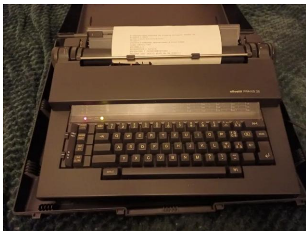
3. ábra: az első elektronikus, margarétakerekes írógép az 1980-ban piacra dobott Olivetti Praxis 35 volt (Forrás: Olivetti SpA)
