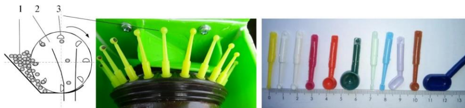
133. ábra. Merítőkanalas vetőszerkezettel rendelkező szemenkénti vetőszerkezet (pannongazda.hu)
