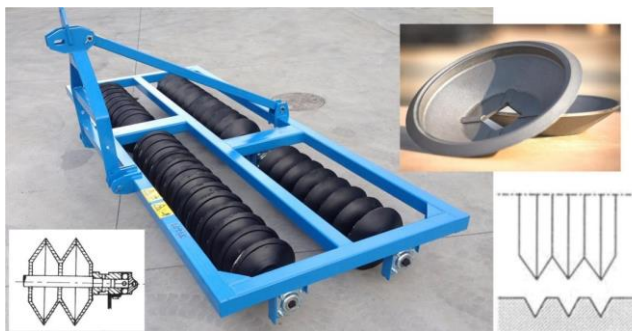
103. ábra. Gyűrűs henger és munkája (letak.hu)
