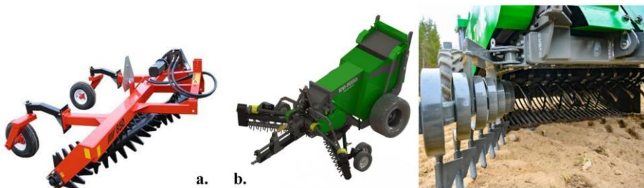
9. ábra. Kőgyűjtő gépek: a – rendre sodró gép; b – gyűjtőtartállyal rendelkező kőgyűjtő gép ( szallitoiadatbazis.ced.hu/termek/korendsodro-gep-0 ; pel-tu-ote.fi/en/kivi-pekka/stone-picker/kivi-pekka-3/ )
