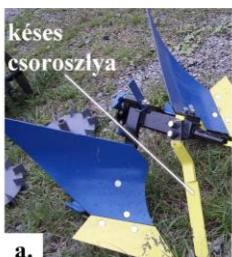
48. ábra. Ekecsoroszlyák: a – késes csoroszlya; b – sima élű tárcsás csoroszlya; c – csipkézett élű tárcsás csoroszlya; d – hullámos élű tárcsás csoroszlya (gardamax.hu)
