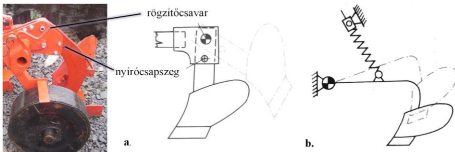
53. ábra. Ekefej-biztosítás: a – nyírócsapszeggel; b – rugóval (Láng 1999)
