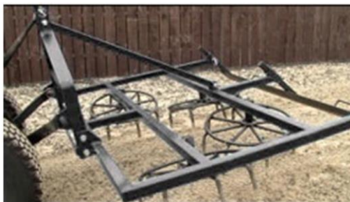
88. ábra. Talajhajtású körborona (Karai 1996)
