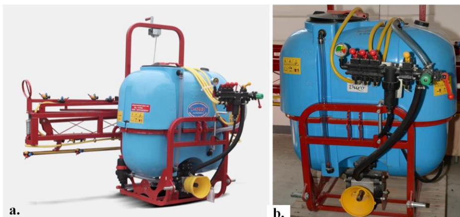
189. ábra. Hidraulikus permetezőgép: a – felépítése; b – szakaszoló ( www.agropark.ro/ )
