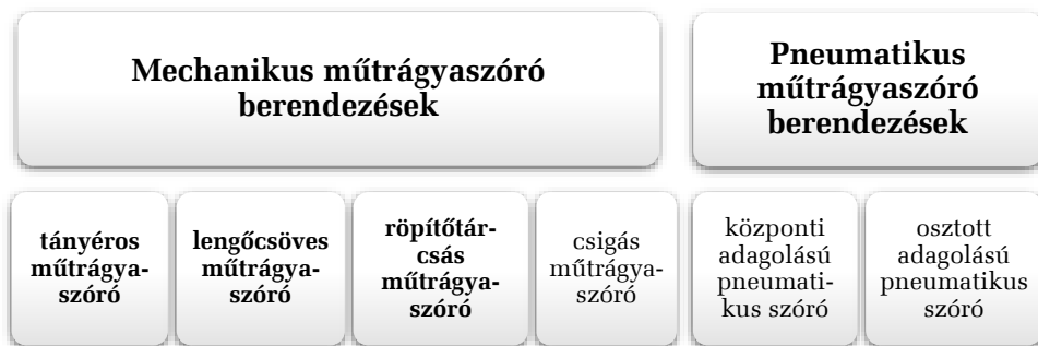
33. ábra. Szilárd műtrágyaszóró berendezések szórószerkezet szerinti csoportosítása
