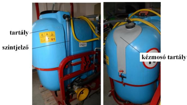
182. ábra. A permetlétartály és tartozékai
