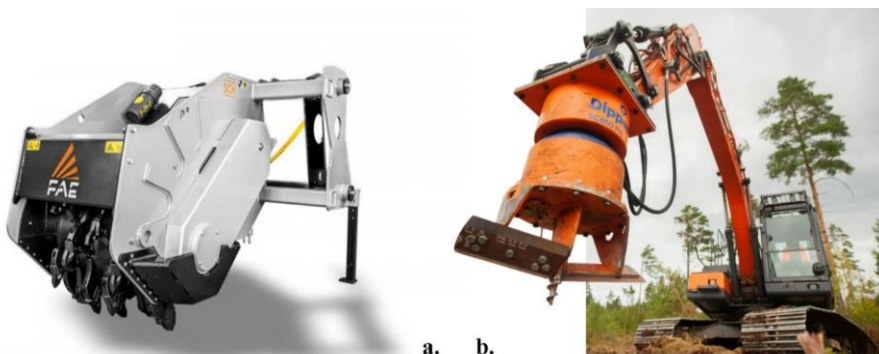
6. ábra. a – tuskómaró gép; b – tuskófúró szerszám ( www.fae-group.com ; dipperfox.com )
