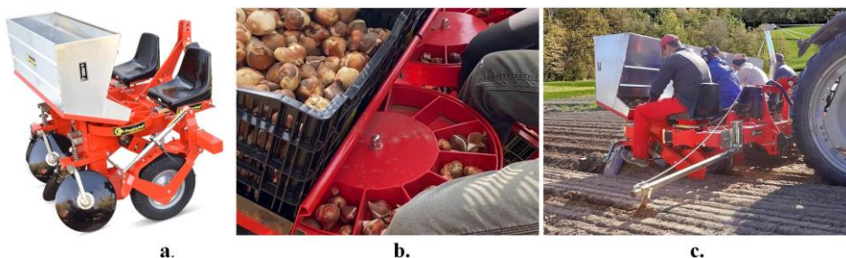
145. ábra. Forgótálcás ültetőgép: a – felépítése; b – cellás forgótálcá; c – ültetés folyamata ( www.hecchiemagli.com/ )
