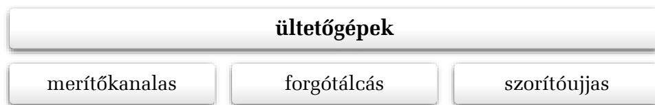
143. ábra. Ültetőgépek adagolószerkezet szerinti csoportosítása
