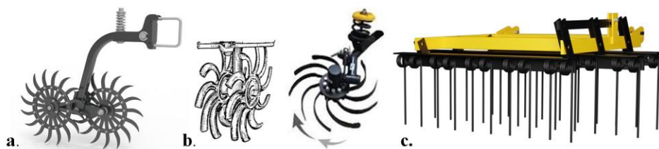
74. ábra. a – küllős kapa; b – forgókapa; c – rezgő gyomfésű (kulloskapa.hu, Láng 1999, busa.hu)
