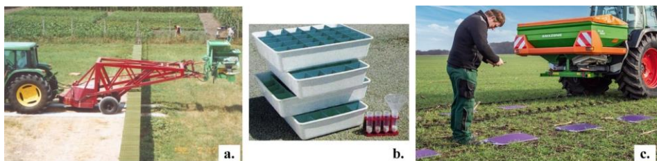
41. ábra. A műtrágyaszóró szórásképvizsgálatának eszközei: a – mérőpálya; b – ellenőrzőtálcák; c – tesztszőnyegek (Kőkuti 2005 alapján)
