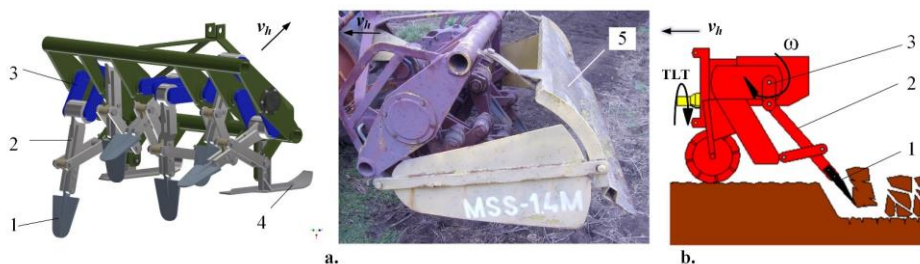
63. ábra. a – ásógép felépítése; b – ásógép működése (gramegna.com)
