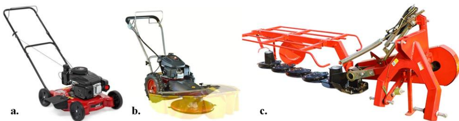
155. ábra. Ellenpenge nélküli fűnyírók: a – forgókéses; b – felülhajtott dobkasza; c – alulhajtott dobkasza ( www.greentehnic.ro , harvestermachinery.com )
