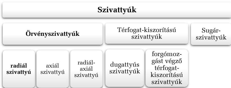
163. ábra. Szivattyúk áttekintése
