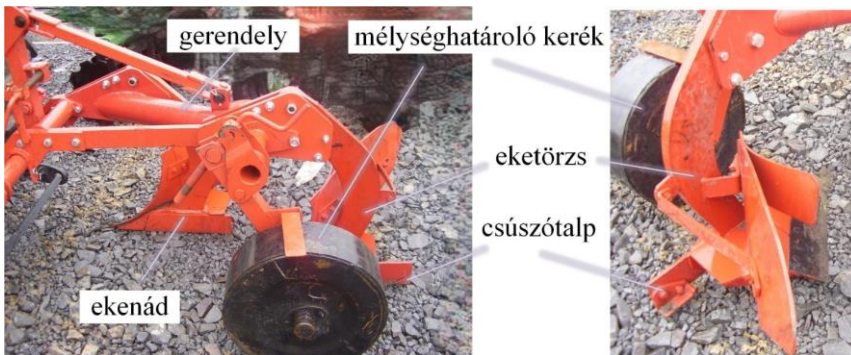
52. ábra. Ekenád, csúszótalp, mélységhatároló kerék, gerendely
