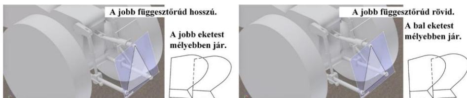
57. ábra. Az eke keresztirányú vízszinteségi beállításának hibája
