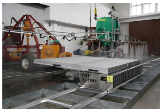
195. ábra. Vízszintes mérővályú hidraulikus permetezőgép ellenőrzésére ( www.inma.ro/incercari-in-regim-acreditat-neacreditat/lims-laborator-incercari-masini-stropit/ )
