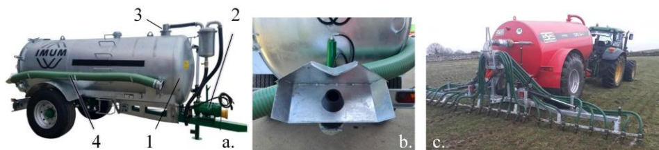
29. ábra. a – kompresszoros tartályos folyékonytrágya-kijuttató gép; b – ütközőtányér; c – szórókeret ( www.ruralplant.ro )
