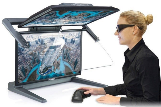
61. ábra. Passzív polarizációs technika ábrázolása, forrás: Target3D 2025
