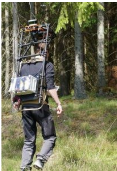
78. ábra. Hátra rögzített mobil lézerszkennelés, forrás: Bohlin 2025
