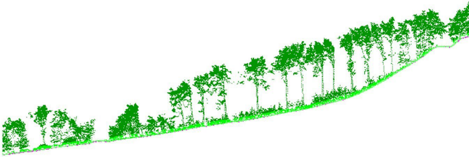
64. ábra. Fásor elemzése drónos felméréssel, forrás: EnviroSense 2025
