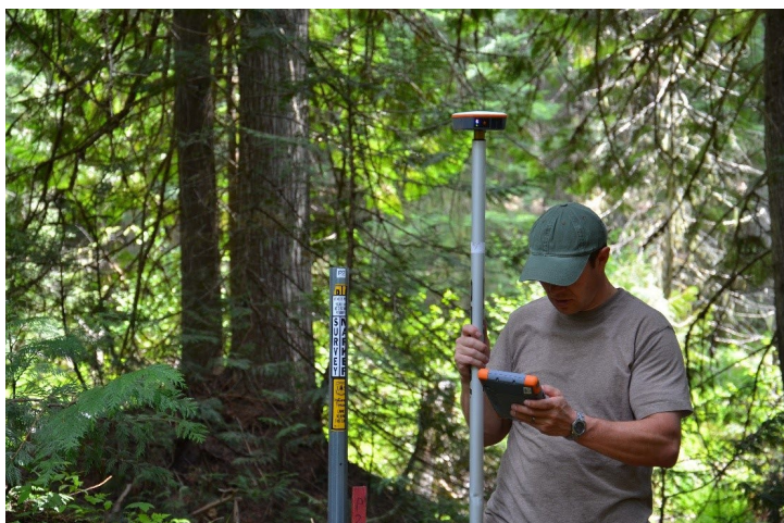
98. ábra. A Geode Submeter GPS-vevő sűrű erdő lombkoronája alatti tesztelése, forrás: Merrell 2017
