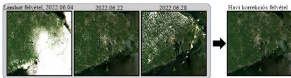
12. ábra. Műholdas felvételek korrekciója és kompozit felvétel készítése, forrás: Aldrich 2023
