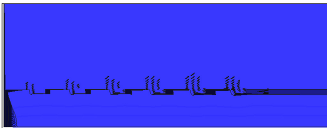
16. ábra: Mikrorepedések statikus terhelés hatására, a tönkremeneteli teher 20%-nál
