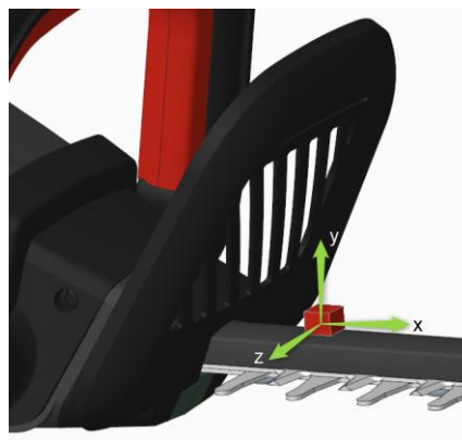
1. ábra: A sövényvágó pengéjénél található szenzor tengelyeinek értelmezése
