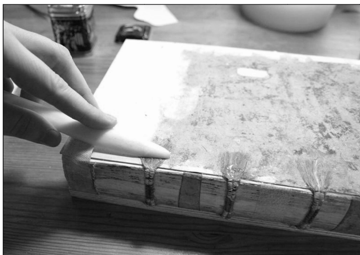
38. kép A betáblázás művelete, a legyezősített bordák leragasztása
