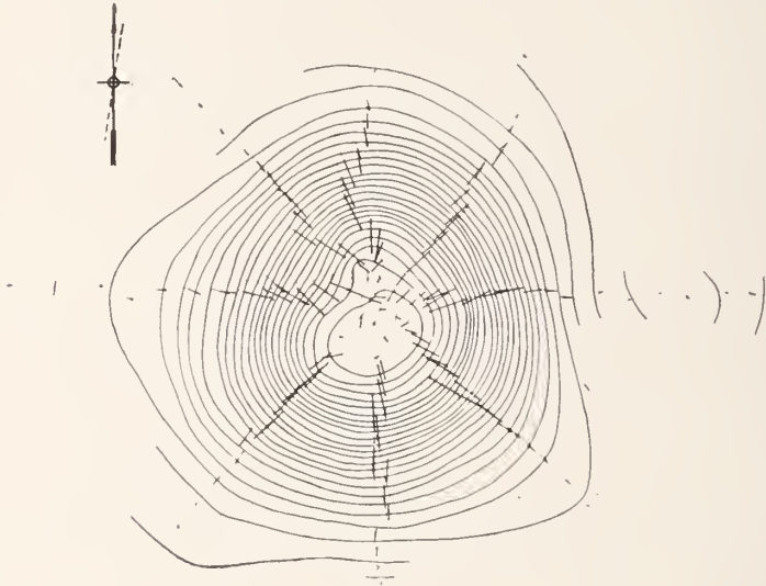
Fig. 1. ábra. Gravitációs maximum sódóm felett. Gravitációs rendellenességek mérete 1 mm = 11.5 E. Isogrammák közé 0.2 \cdot 10^{-3} C. G. S. Térképméret 1: 57.300. — Gravity maximum on a salt dome. Scale of gravity anomalies 1 mm = 11.5 E. Isogram interval 0.2 \cdot 10^{-3} C. G. S. Scale of map 1: 57.300.
