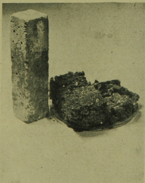
2. ábra. A baloldali gázkezelt betonhasáb tömény kénsav hatására három nap után sem mutatott elváltozást, míg a kezeletlen próbatest a jobboldalon látható módon teljesen szétesett. (Betonhasáb összetétele: 400-as selypi cement 1 súlyrész, dunakavics 3,5 súlyrész.)
