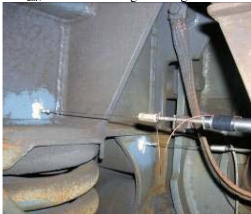
Járműszekrény és forgóvázkeret közötti relatív elmozdulás mérése
