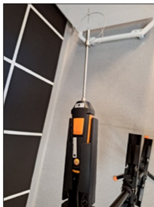
Fig. 8. Testo turbulence probe
