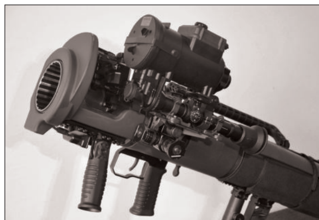
9. ábra. A KN250 MK3 XR5 éjjellátó előtét az 557B jelű, elsődleges optikai irányzéken (Fotó: Birinyi János)
