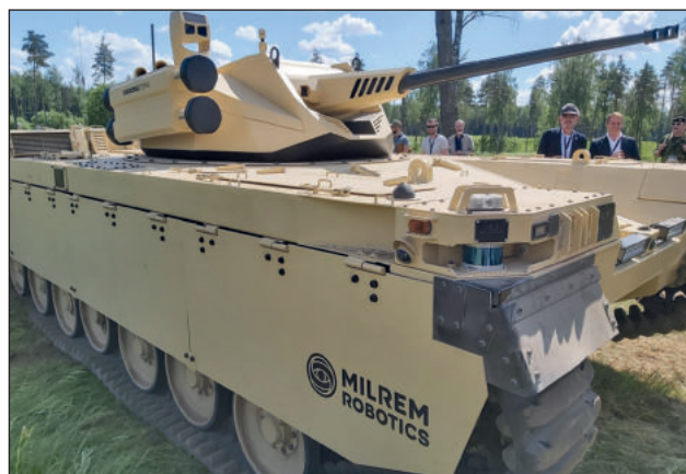
10. ábra. A Milrem Type-X vezető nélküli harcjármű, Cockerill 25 mm-es géppuskával rendelkező toronymakettel szerelve (Fotó: Ocskay István)
