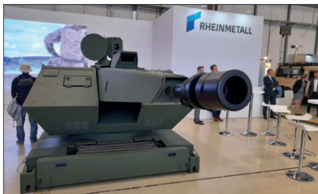
2. ábra. A Rheinmetall cég Skyranger légvédelmi tornyának 35 mm-es gépágyúval felszerelt változata. A német céggel kötött megállapodás értelmében a 30 mm-es, majd a 35 mm-es gépágyúval szerelt változatot a hamarosan Zalaegerszegen gyártásra kerülő Lynx gyalogsági harcjárművekre szerelik (Fotó: Zsig Zoltán)
