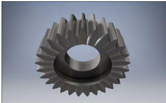
10. ábra. Metszőkerék 3D-modellje
