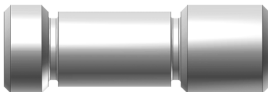
2.99. ábra A megforgatással létrehozott testmodell
