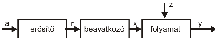
2.57. ábra Vezérlés blokkvázlata
