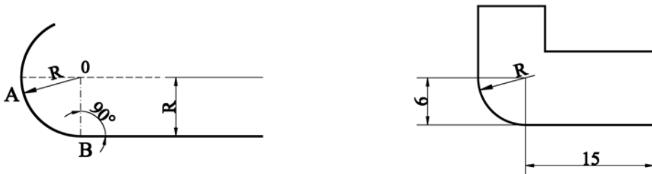
32. ábra. Csatlakozási körív középpontjának meghatározása (Popa-Müller, 2004, o. 28.)
