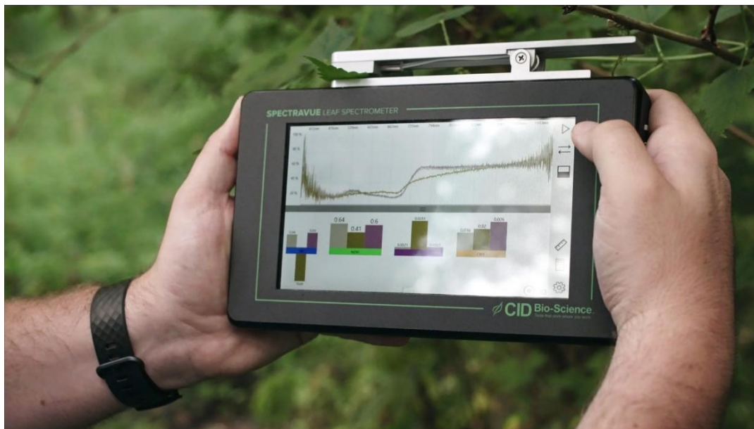
3. ábra. Tipikus reflexiós spektrum a CI-710s levélspektrométeren.
