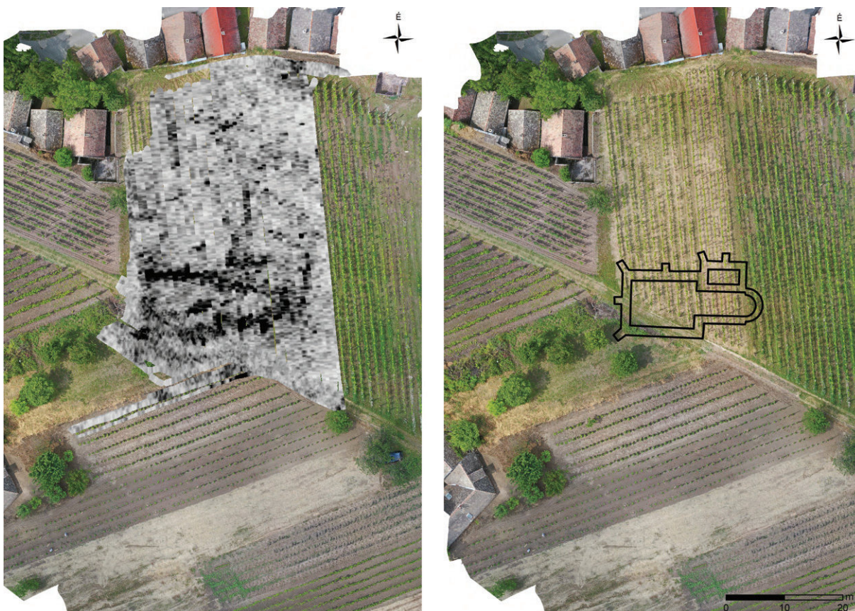
Figure 7 – Left: Ground-penetrating radar image (60 cm depth) of the church, Right: hypothetical layout of the church 7. kép – Balra: az egykori templom radarképe (60 cm mélység). Jobbra: az épület feltételezett alaprajza
