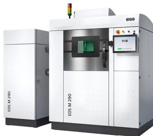
1. ábra EOS M290 DMLS fém 3D nyomtató [11]
