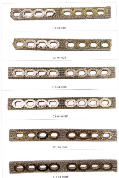
9. ábra A kinyomtatott Cubic1-0,4 típusú csontlemezek
