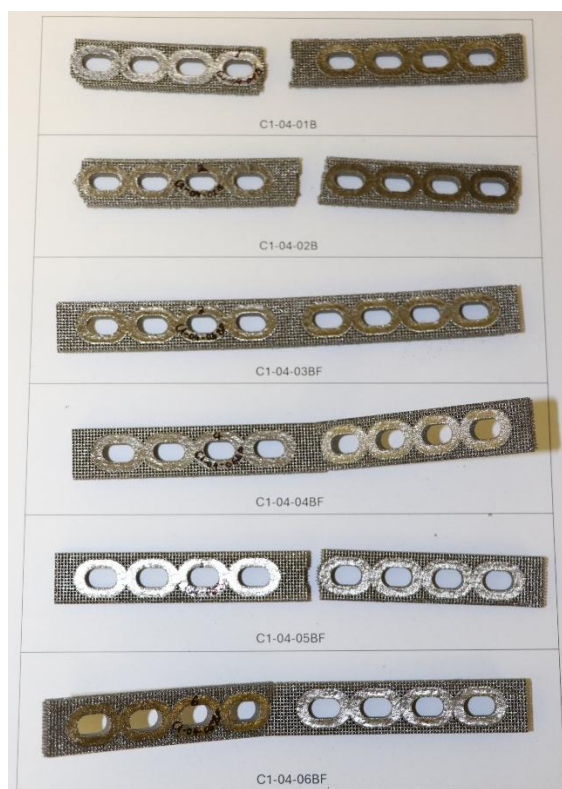
14. ábra A Cubic1-0,4 típusú csontlemezek a statikus törésvizsgálatok után
