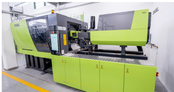
1. ábra: Az Engel E-Mac 465/180 Fast Track elektromos fröccsöntő gép
