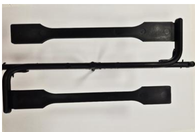
15. ábra: Fröccsöntött szakító próbatest
