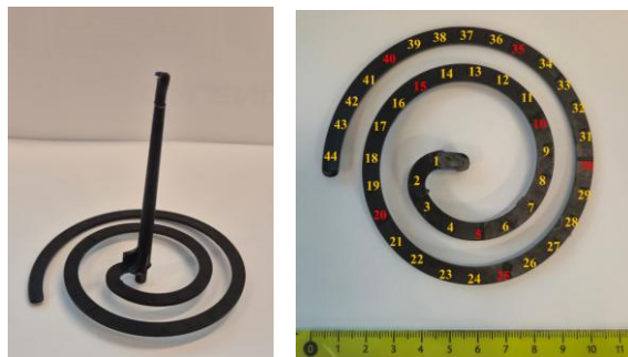
12. ábra: Spirál folyási PP próbatestek
