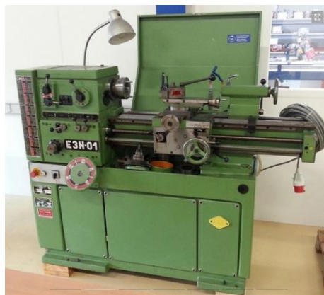
31. ábra. SZIM E3N-01 – hagyományos, egytetemes esztergagép, a Szerszámgépipari Művek gyártmánya [28]
