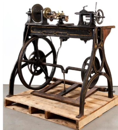
6. ábra. Lábajtású eszterga [3]
