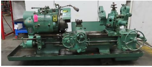
16. ábra. egy klasszikus, ipari tömegtermelésre tervezett revolvereszterga (1940-es és 1950-es évek) (méretpontosság kb. \pm 0,02-0,05 mm, felületi érdesség kb. R_a=1.6-25 \mu\text{m} ) [10]
