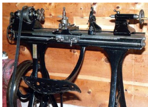
11. ábra. Öntöttvas gépágyas precíziós esztergagép (1860–1890 közötti időszak) (méretpontosság kb. \pm 0,02\text{--}0,05\text{ mm} , felületi érdesség kb. R_a=1,6\text{--}3,2\text{ }\mu\text{m} ) [6]
