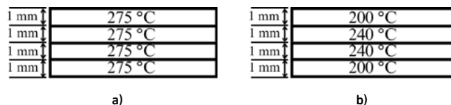
△ 1. ábra: Nyomtatott habszerkezet (a) és szendvicsszerkezet (b)
