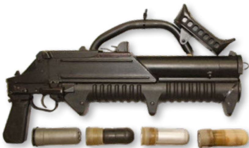
1. ÁBRA. 43 mm-es GM-94 típusú, orosz gyártású gránátvető és rendszeresített löszertípusai, köztük a VGM-93 típusú termobárikus töltettel szerelt gránát a jobb szélén (Forrás: Shutterstock)
