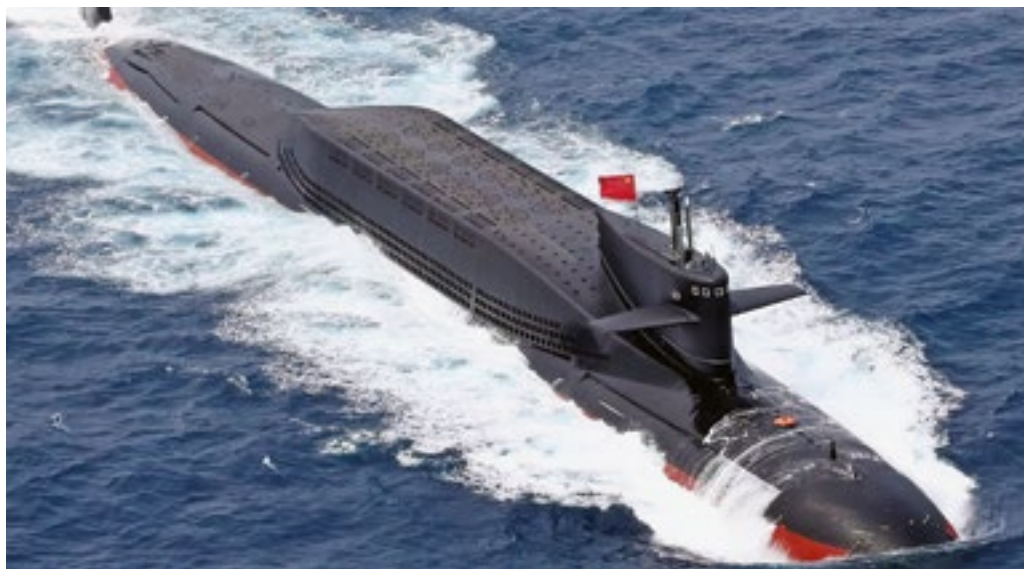
4. ÁBRA. Kínai Type 094 Jin-osztályú SSBN. Nem tűnik a legkorszerűbbnek: a kiálló részekkel épített, nem túl áramvonalas és zajkeltő hajótörzse leginkább az elavult orosz Delta-osztályra emlékeztet, de még így is komoly fenyegetést jelent [17]
