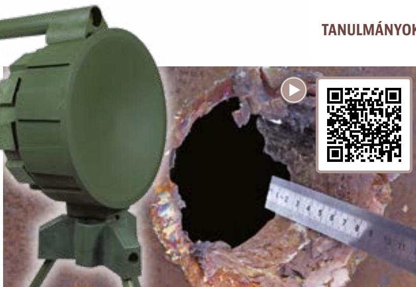
13. ÁBRA. A képeken az észtt gyártmányú PK-14 parancsvezérelt oldal elleni akna, valamint EFP-töltetének hatása látható. Az eszközről részletesebb információ a mellékelt QR-kód beolvasásával érhető el [17]
