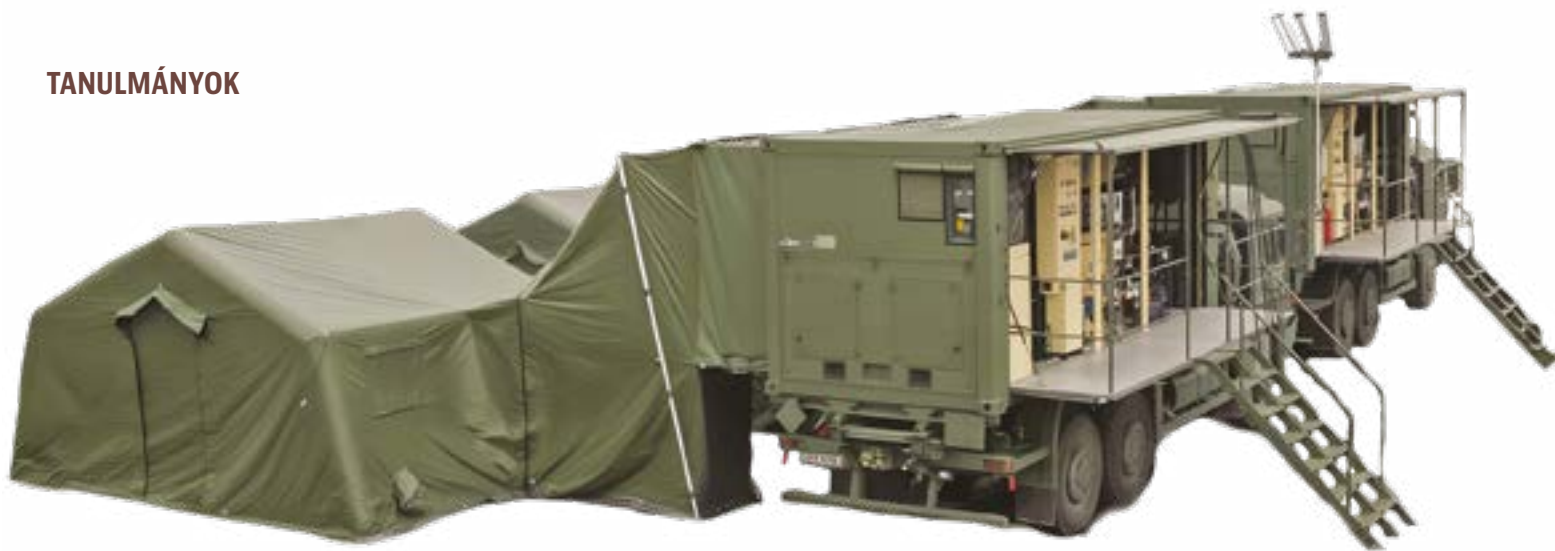
15. ÁBRA. Telepített Konténeres Mentésítő Berendezés [4]
