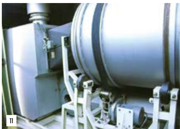
11. ÁBRA. A mosást végző forgódob (Fotó: Farkas Zoltán)
