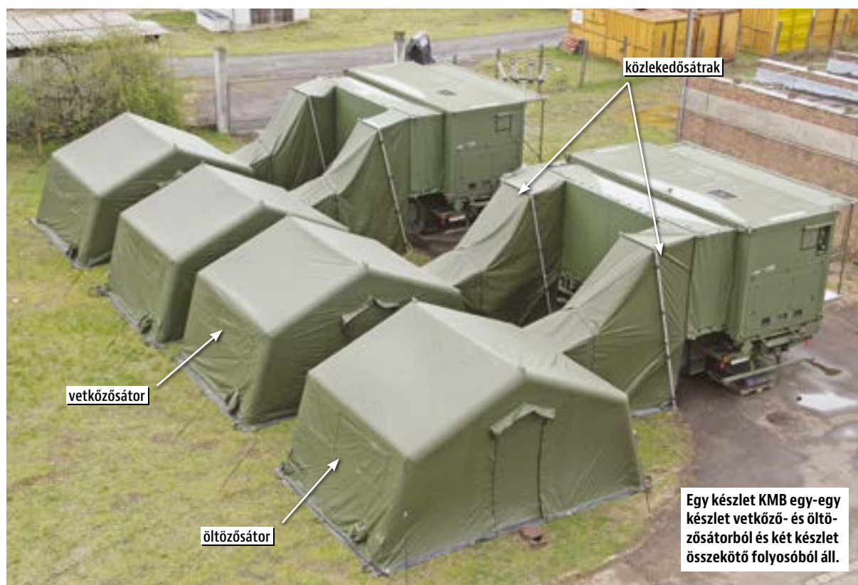
14. ÁBRA. A Konténeres Mentés Berendezés főbb részei [5]
