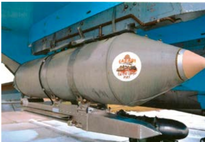
10. ÁBRA. Felfüggesztett ODAB-1500 típusú orosz termobárikus légibomba [7]
