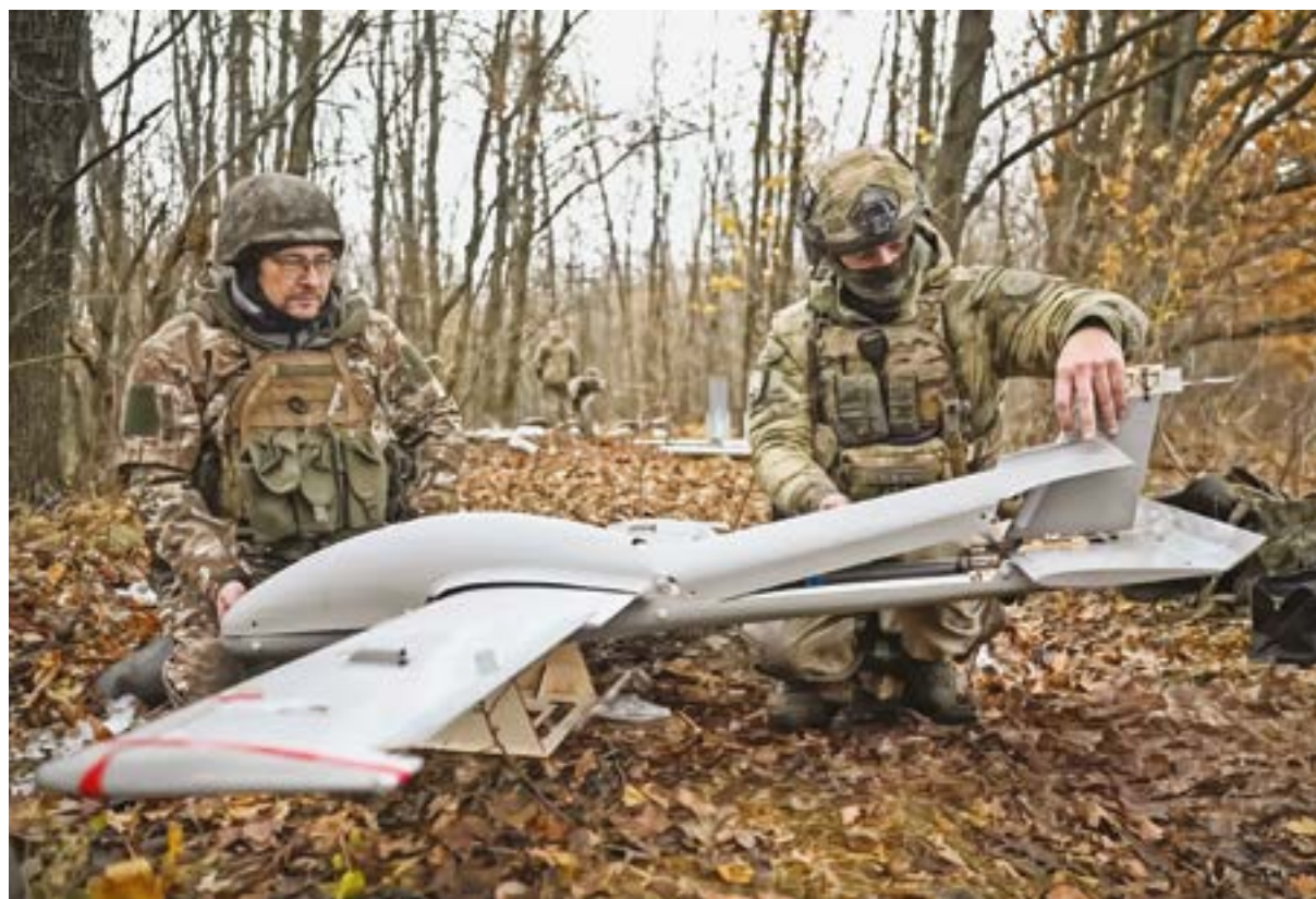
6. ÁBRA. A Molnija-2 kamikaze drón az egyik legegyszerűbb és legolcsóbb cirkáló lövész, ugyanakkor hatékony típus [17]
