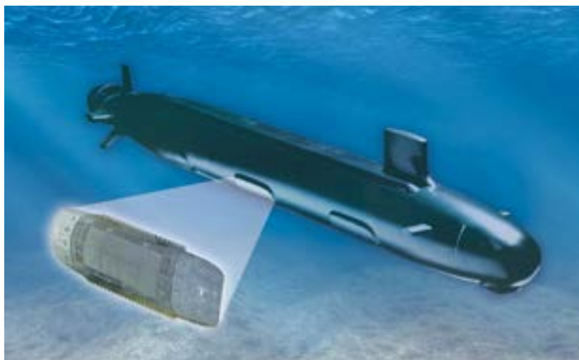
2. ÁBRA. A tengeralattjáró jobb oldalára felszerelt LWWAA-készlet egyik szenzorának illusztrációja. A panelrendszer szenzorai teszik lehetővé a Virginia-osztály számára a sekély vizekben folytatott biztonságos manővereket [7]
