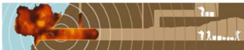
3. Másodlagos robbanás: a lökéshullám beáramlik a barlangba (akár szuperszonikus sebességgel is).
