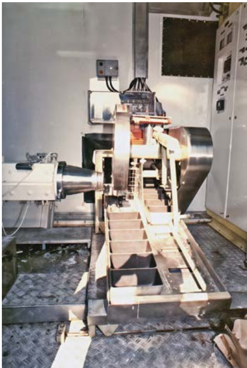
10. ÁBRA. Osztogép a formaáthordó szerkezettel [4]
