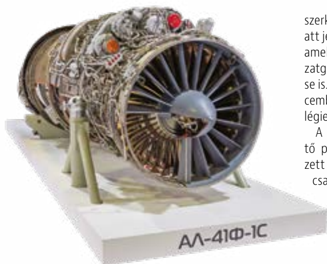
4. ÁBRA. A Szu-57 vadászpilóta nélküli repülőgéptípus AL-41F1 típusú tolóerővektoros hajtóműve (Forrás: Shutterstock)
