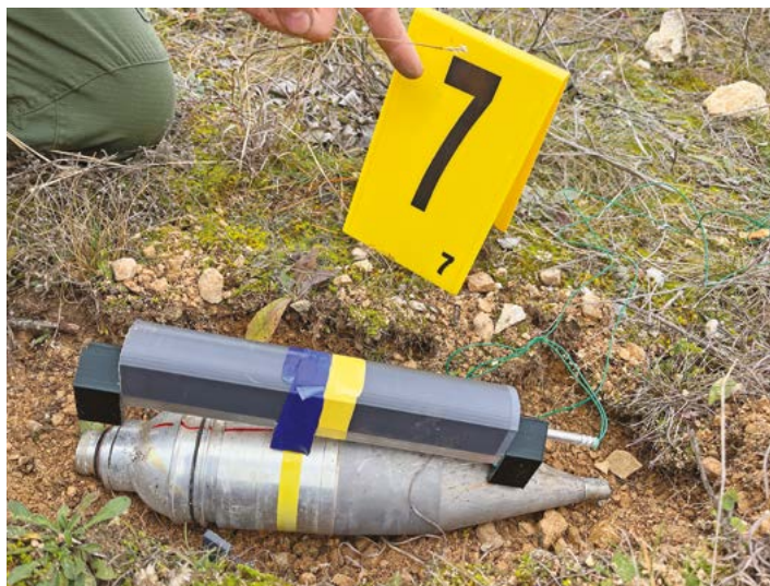
9. ÁBRA. AT4 HEAT lövedéken elhelyezett kumulatív vágótöltet; jobbra a teljesen megsemmisült lövedék (Fotók: Bokros Tünde Ibolya)
