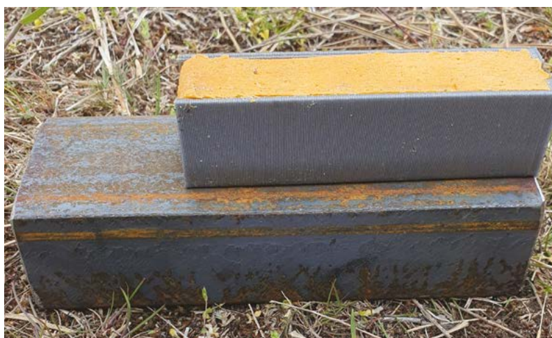
5. ÁBRA. Vágótöltet plasztikus robbanóanyaggal töltve (A szerzők felvétele)
