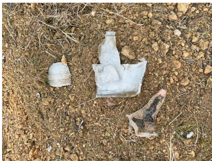
9. ÁBRA. AT4 HEAT lövedéken elhelyezett kumulatív vágótöltet; jobbra a teljesen megsemmisült lövedék (Fotók: Bokros Tünde Ibolya)
