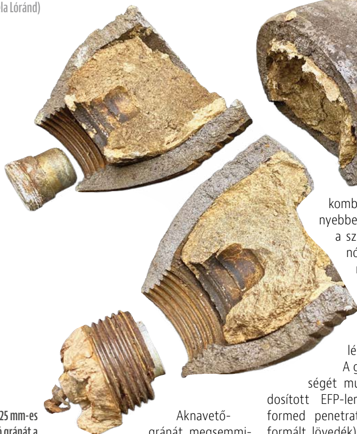
11. ÁBRA. Kis méretű EFP-töltettel széttrött inert gránáttest (Fotó: Kugyela Lóránd)
