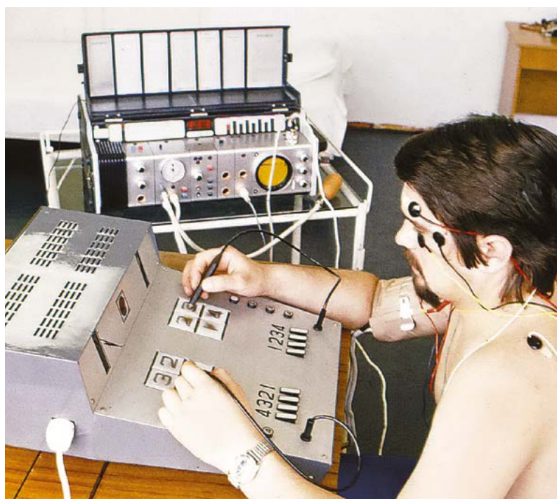
8. ÁBRA. A percepciósi műszer képes volt a négyválasztásos reakciódíó mérésére (A szerző felvétele)
