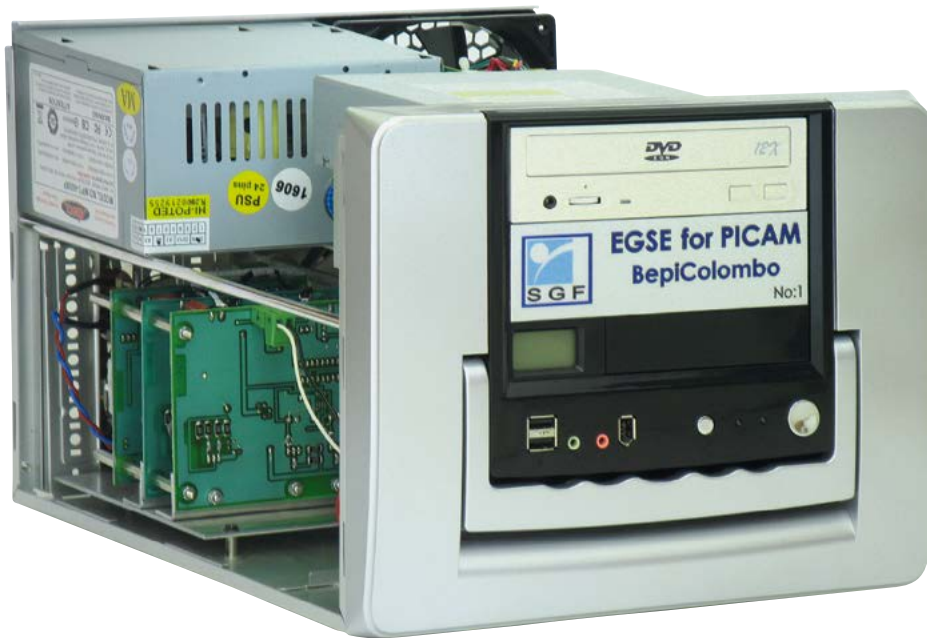
8. ÁBRA. A PICAM bemérését szolgáló jelszintű szimulátor (Fotó: SGF Kft.)
