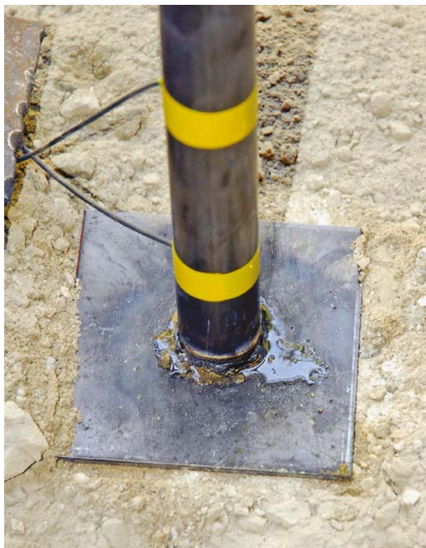
3. ÁBRA. A szétvált robbanóanyag-rendszer folyadékfázisa, klasszikus KINEPAK keverék esetén (Fotó: Kugyela Lóránd)
